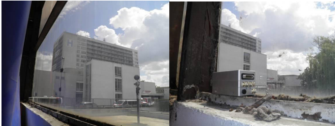
Obr. 3.7 Meracie referenčné stanovisko S2 v meracom bode S2 (vľavo) na ocelovom nosníku okna štadióna Vladimíra Dzurillu v Bratislave. Digitálna seizmická aparatúra Vibracloc ABEM na meracom bode S2 (vpravo)
