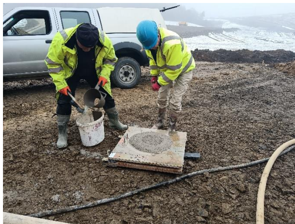
Objekt: SO 402-00-01-11-01 Skúška rozliata betónu, metóda VEBE doska Dátum: 20.10.2023
