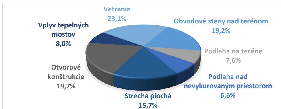
Obr. 43: Podiel konštrukcií a tepelných mostov na celkovej mernej tepelnej strate
