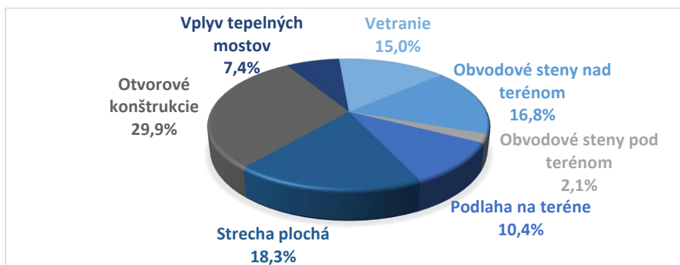
Obr. 23: Podiel konštrukcií a tepelných mostov na celkovej mernej tepelnej strate
