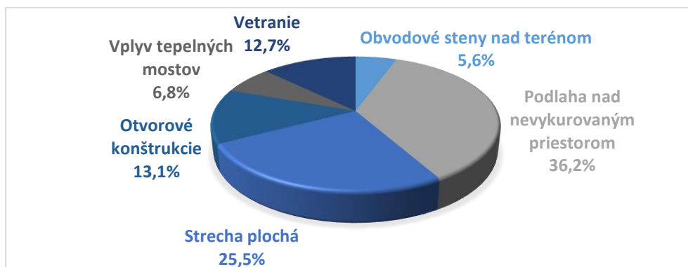
Obr. 48: Podiel konštrukcií a tepelných mostov na celkovej mernej tepelnej strate
