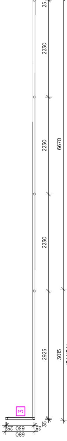
KONSTRUKCE SLOUPEK Ø 50 mm -
