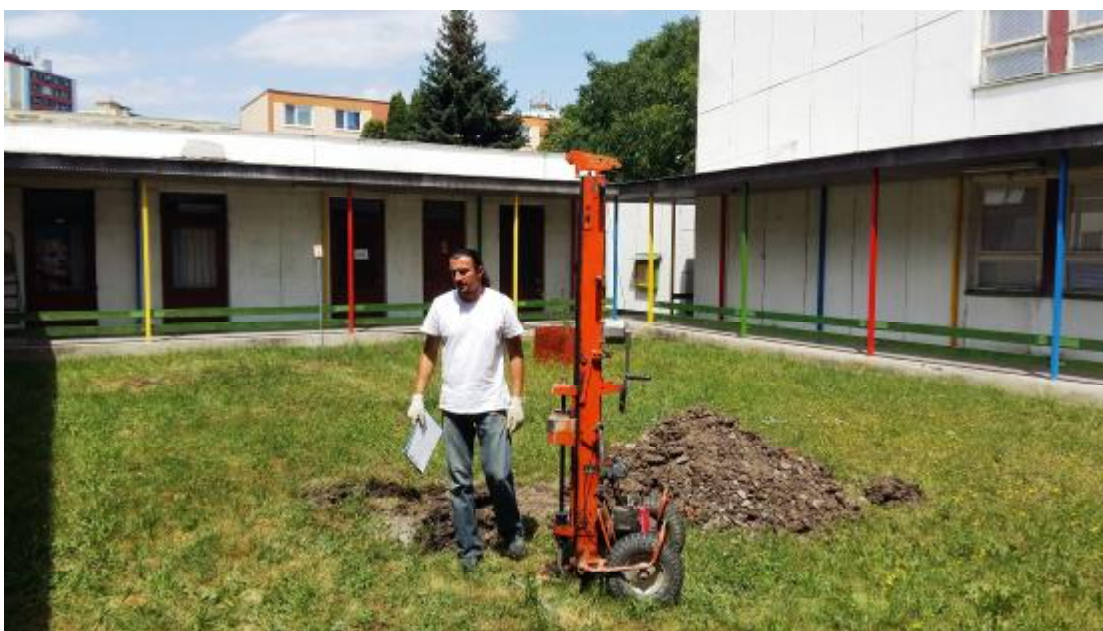
Vykonávanie dynamických penetračných skúšok
