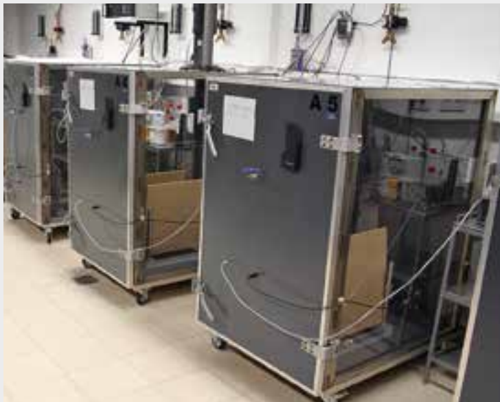
Zkušební komory o objemu 1 m 3 ve Fraunhofer institutu pro výzkum dřeva WKI.
