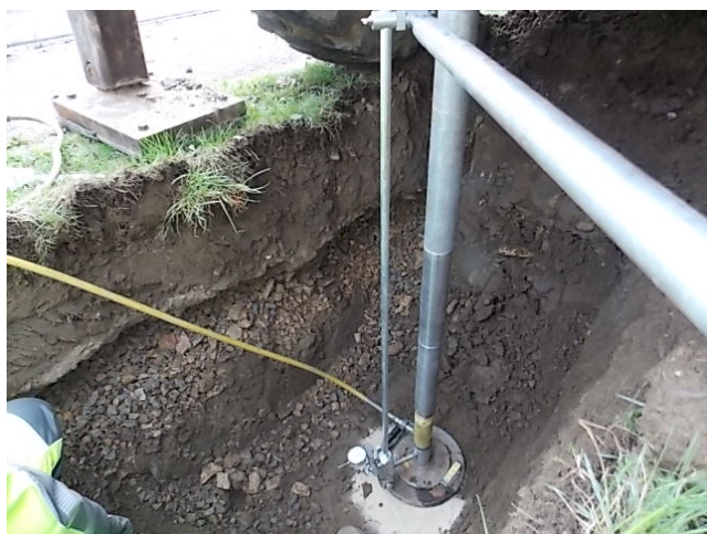
Obrázok 7 Statická zaťažovacia skúška v hĺbke 1,1 m
