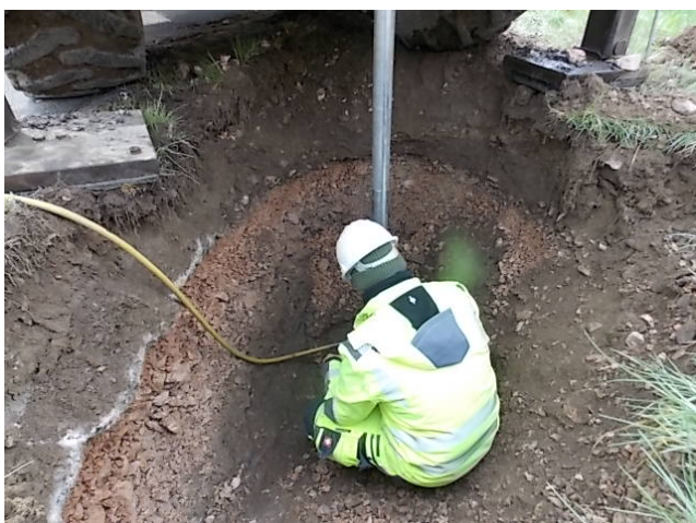
Obrázok 5 Realizácia statickej zaťažovacej skúšky v sonde SZS18-03
