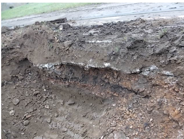
Obrázok 1 Pod vrstvou betónu kamenitá drť so sivou znečistenou polohou
