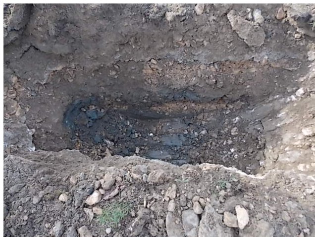
Obrázok 10 Sivý íl na báze kopanej sondy
