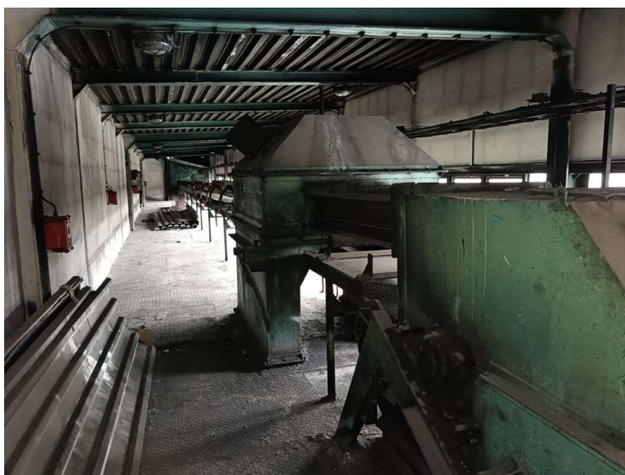
Obr. Kotelna, horní část dopravníku - nefunkční technologie k demontáži
