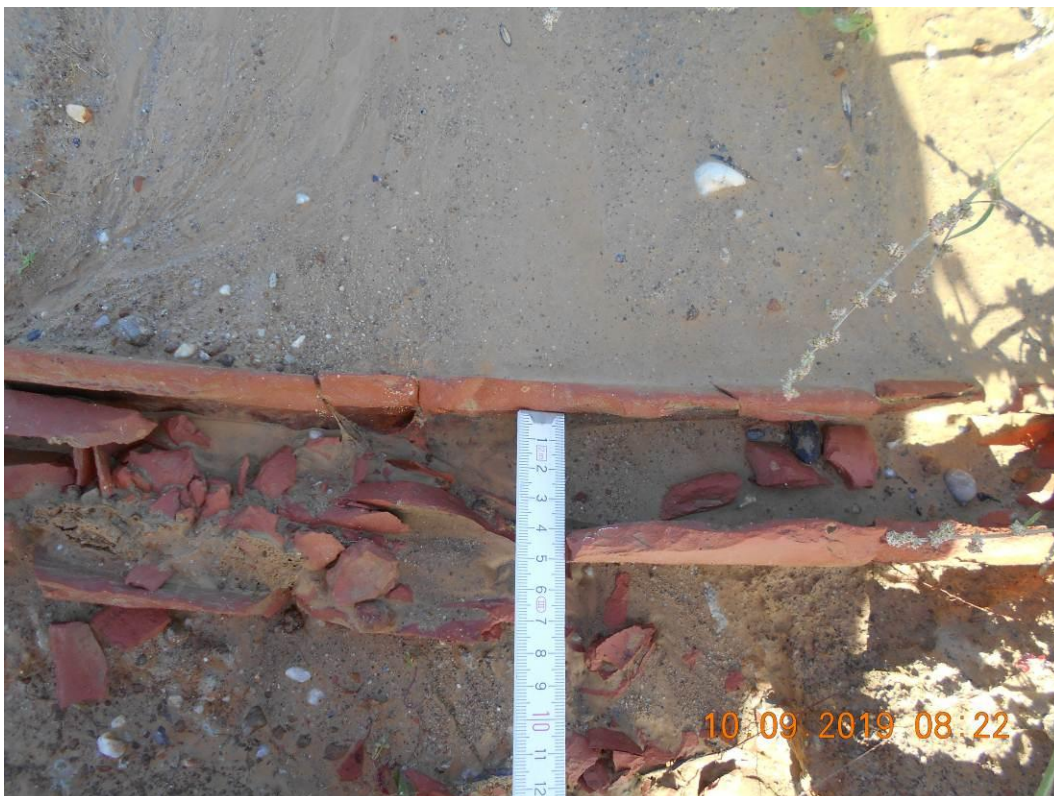
Fotogram nr 7 pozostałości systemu melioracyjnego, materiał ceramiczny
