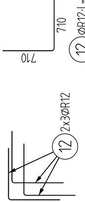
DET.1 – TYP. PREVIAZANIE ROHOV – 7x M 1:25
