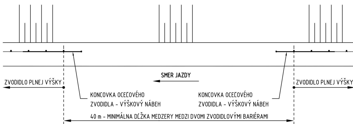
Obrázok 3: Medzera medzi zvodidlovými bariérami
