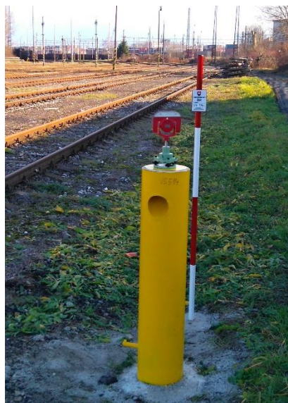
Obr. č. 1 Vzor piliera s nútenou centráciou
