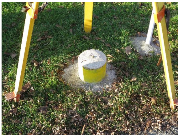
Obr. č. 2 Vzor piliera v úrovni terénu
