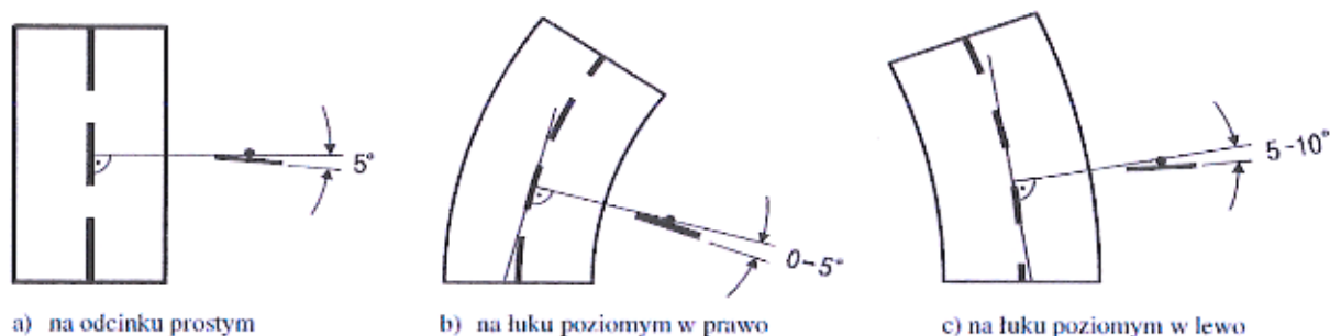
Rys. 1. Odchylenie poziome tarczy znaku
