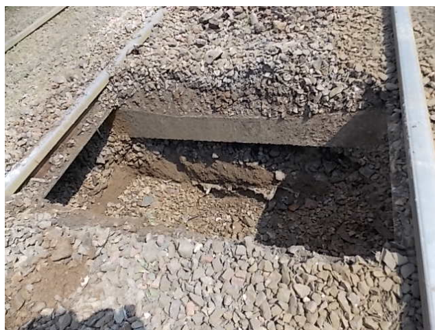
Obrázok 13 Kopaná sonda SZS17-07 pre statickú zaťažovaciu skúšku
