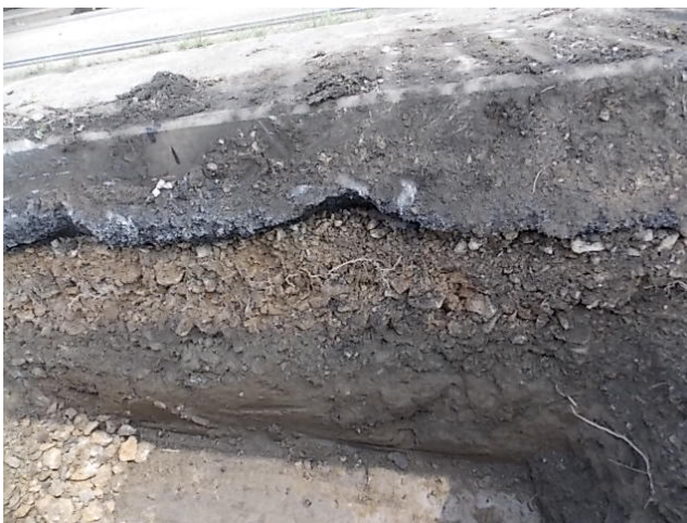
Obrázok 27 Geologický profil kopanej sondy SZS17-18
