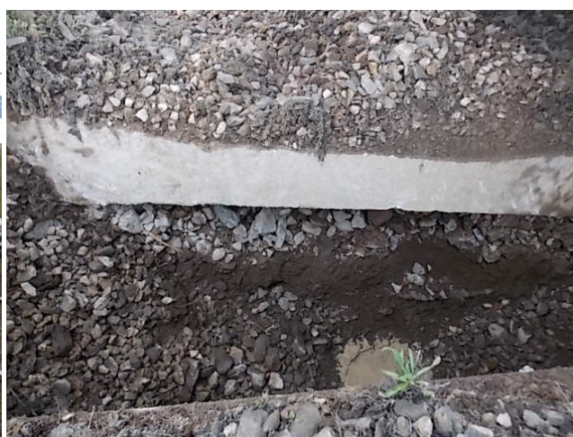
Obrázok 7 Kopaná sonda medzi podvalmi pre statická zaťažovaciu skúšku
