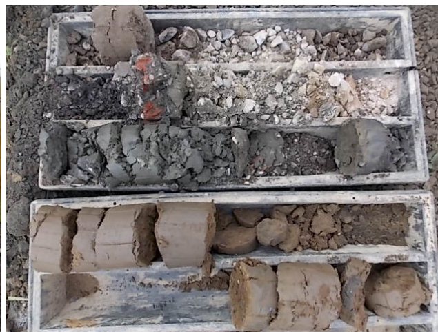
Obrázok 11 Násypový materiál zachytený vrtom UČS17-12
