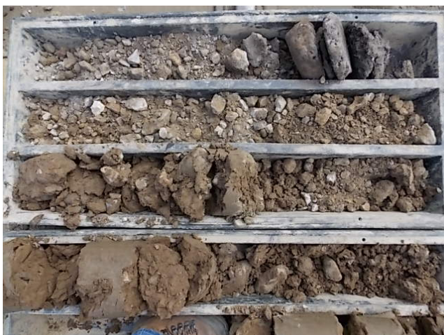
Obrázok 20 Geologický profil vrtu UČS17-16 v osi trate
