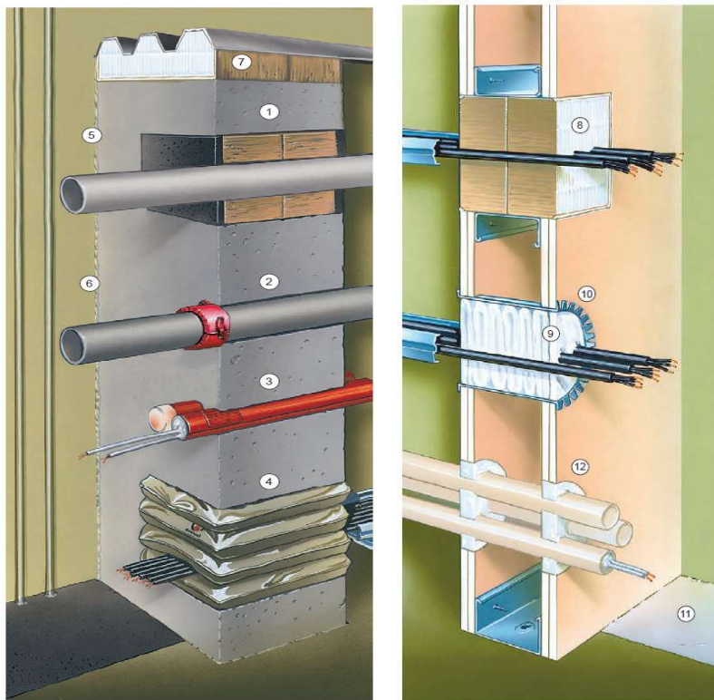
Rys. 2. Zabezpieczone przepusty instalacyjne
