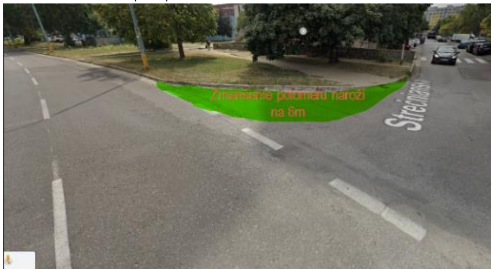
Obrázok 7. Požadovaná úprava polomerov v nároží
