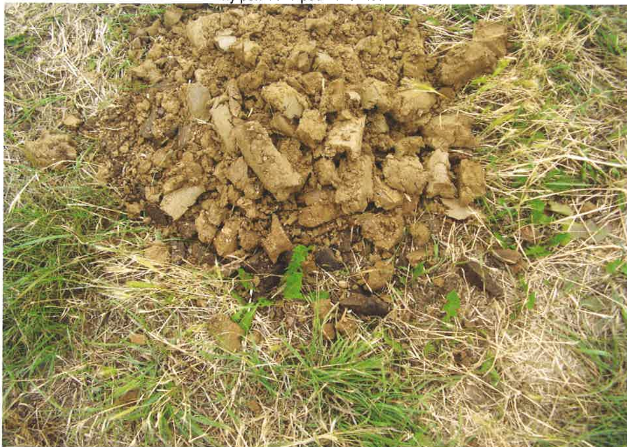
Foto č.4 : jílovité hlíny až jíly tuhopevné až pevné v sondě VJ 4
