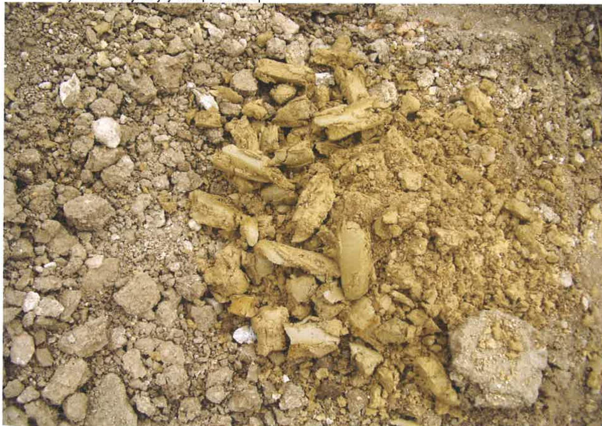
Foto č.4 : jílovité hlíny až jíly tuhopevné až pevné v sondě VJ 4
