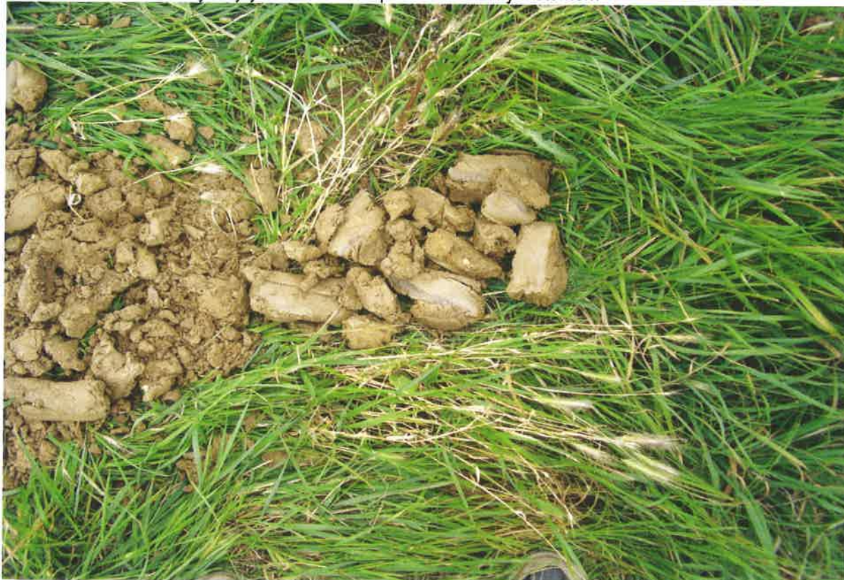
Foto č. 2 : Jílovité hlíny až jíly – deluviálního původu s drobným štěrskem
